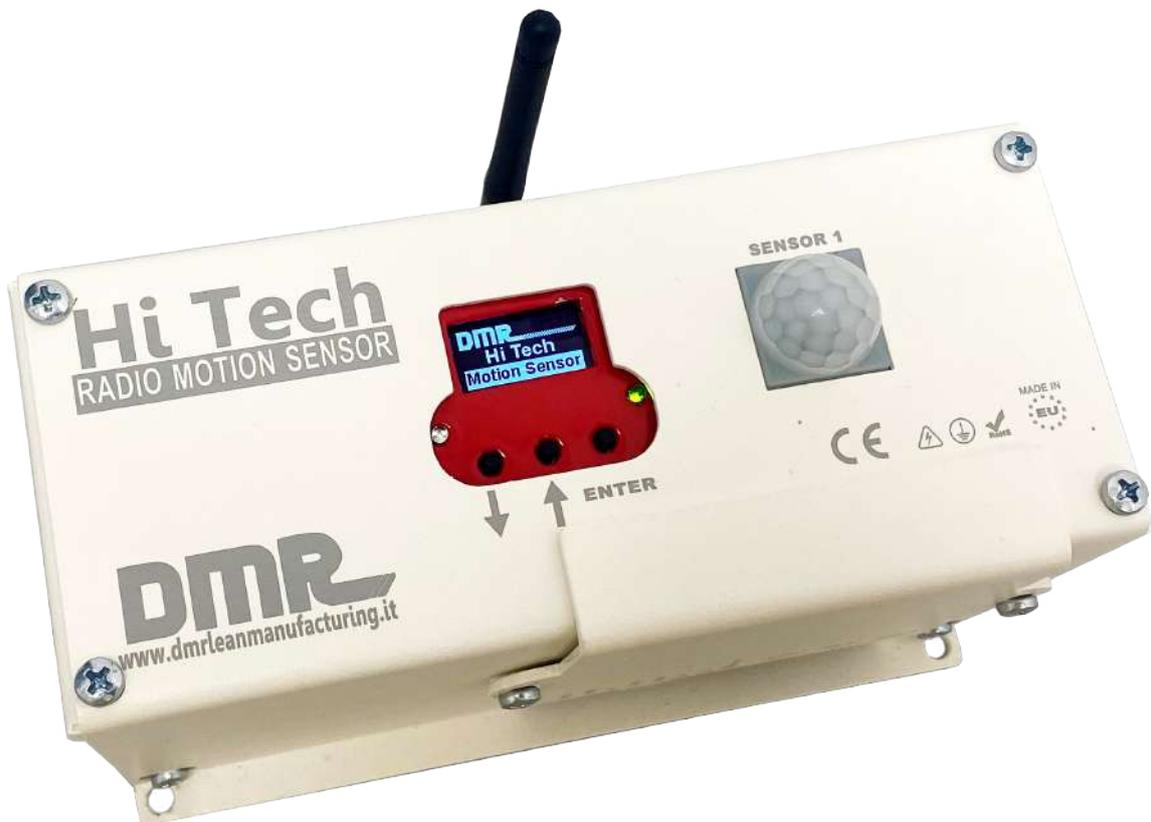
Il centralino **HiTech Radio Motion Sensor** è un dispositivo per la gestione temporizzata di segnali input/output, dotato di un sensore di rilevazione di movimento (PIR), studiato per applicazioni in ambienti industriali e in ambiti prevalentemente dedicati alla sicurezza.
