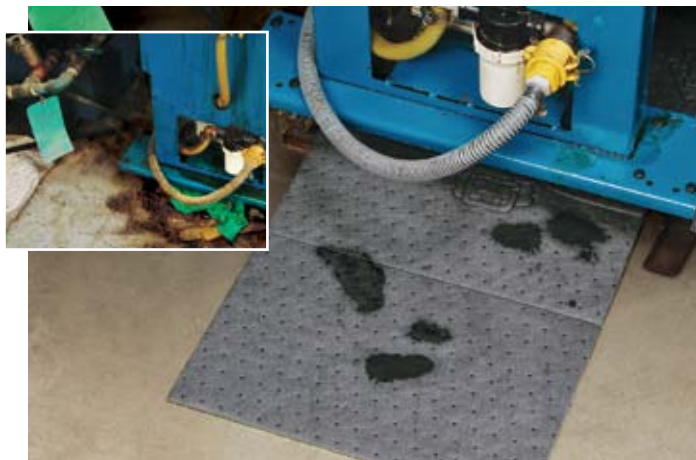
Perdite e gocciolamenti delle macchine
