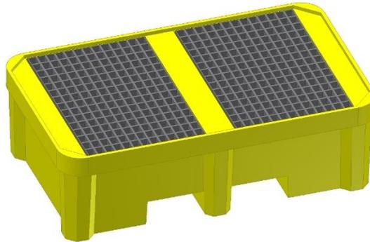
Vasca di contenimento realizzata in polietilene atossico stabilizzato U.V. di colore giallo, roto-stampato monolitico (stampato in unico pezzo senza giunzioni) con struttura auto portante e rinforzata per resistere agli urti, resistente agli agenti chimici, dotata di due griglie in polietilene asportabile per una facile pulizia, sormontabile a vuoto, pallettizzata per un'agevole movimentazione con muletto o trans-pallets.
