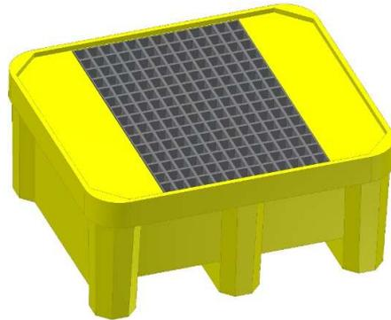
Vasca di contenimento realizzata in polietilene atossico stabilizzato U.V. di colore giallo, roto-stampato monolitico (stampato in unico pezzo senza giunzioni) con struttura auto portante e rinforzata per resistere agli urti, resistente agli agenti chimici, dotata di griglia in polietilene asportabile per una facile pulizia, sormontabile a vuoto, pallettizzata per un'agevole movimentazione con muletto o trans-pallets.
