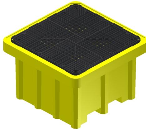
Vasca di contenimento realizzata in polietilene atossico stabilizzato U.V. di colore giallo, roto-stampato, monolitico ovvero stampato in unico pezzo senza giunzioni con struttura auto portante e rinforzata per resistere agli urti, resistente agli agenti chimici, dotata di una griglia in polipropilene asportabile per una facile pulizia, sormontabile a vuoto. Movimentazione con muletto o trans-pallets a vuoto.
