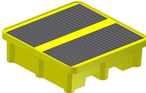
Vasca di contenimento realizzata in polietilene atossico stabilizzato U.V. di colore giallo, roto-stampato monolitico (stampato in unico pezzo senza giunzioni) con struttura auto portante e rinforzata per resistere agli urti, resistente agli agenti chimici, dotata di due griglie in polietilene asportabile per una facile pulizia, sormontabile a vuoto, pallettizzata per un'agevole movimentazione con muletto o trans-pallets.
